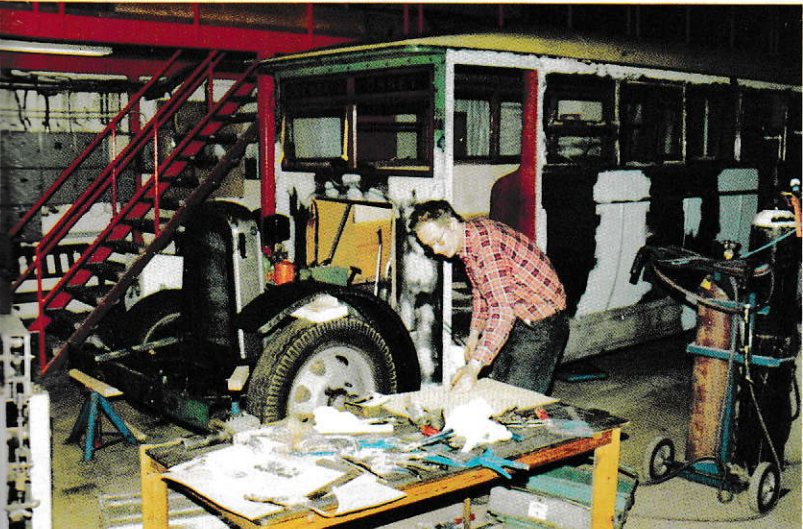
Ovan: Norske plåtslagarmästaren Geir Jonassen gör sig en mall till bussens torped.
