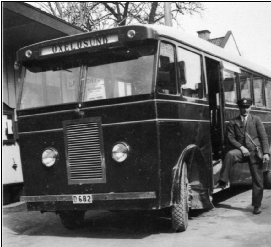
D682 var Trafik AB Ivan Thors första bulldogbuss. Den var byggd på ett Volvochassi av 1932 års modell. Karossen anges vara byggd av "Järbo Karosserifabrik" och hade plats för 31 passagerare. Chauffören (på bilden) hette Einar Fredriksson. Förmodligen är detta en av få bussar som A.-B. Järbo Karosserifabrik byggde åren 1931-32. Bild från Sörmlands museum.
