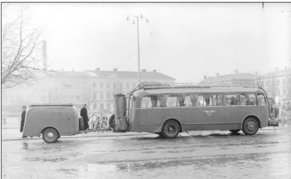
Släpvagn byggd av Järbo Karosserifabrik. Bild nr XLM.CL003635-4 från Länsmuséet Gävleborg. Foto Carl Larssons Fotografiska Ateljé AB. Fotoår 1950 anges, men bilden bör vara tagen flera år tidigare, kanske ca 1944-45, eftersom bussen har gengasaggregat. Bussen tillhör tydligen GDG och står på busstorget i Gävle.
