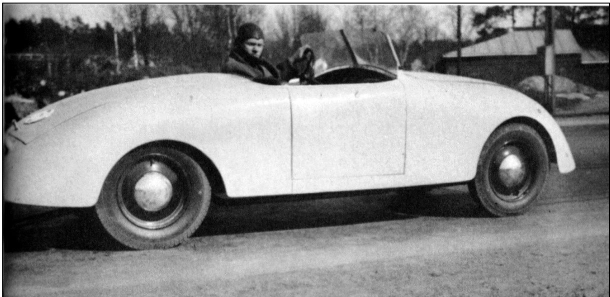
I början av 1939 byggdes denna sportbilskaross på ett FIAT 508 C-chassi på uppdrag av tävlingsföraren Martin Strömberg. På fakturan står det "racerkarosseri". Priset var 330 kr efter att rabatten fem procent dragits av. Bild ur boken Svenska Karosserimakare.
