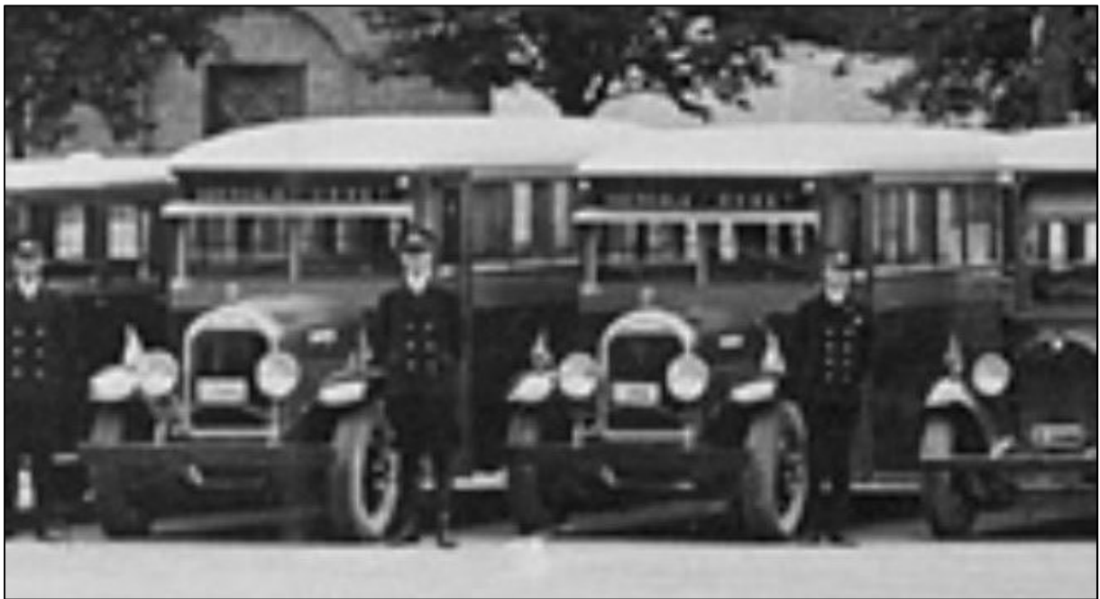
TVå bussar som är speciellt omskrivna är de till Bohmans Omnibusbolag i Östersund 1929, byggda på Brockway-chassier. De erhöLL reg.nr Z2661 och Z2662. Redan 1936 ansågs dessa omoderna och degraderades i sin tjänst. Z2661 såldes 1938 och ställdes upp som sommarstuga, medan Z2662 brann 1937. 1988 hittades Z2661 och började renoveras. Brockway-bussarna Z2662 och Z2661. Foto genom Per Erikson / Veteranbilklubben.
